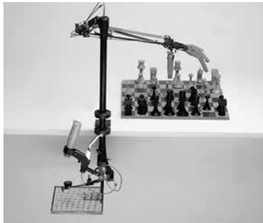
Nachbau der Steuerung von Kempelens Schachautomat aus der „Kempelenbox“ von Jakob Scheid (Wien 2003)
